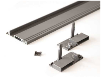
B491 لوازم اینتر ریل اسلیم با فرانت آلومینیوم و ارتفاع ۱۰۶mm سایز برش فرانت آلومینیومی : عرض داخل به داخل - ۹۷mm
